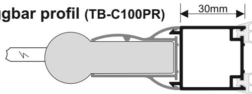
Kan användas för enkel och snygg montering av tex utanpåliggande rör. Profilen eller profilerna "snappar" fast och läses fast med skruv. Bygger 30 mm. Använder man två profiler ger det ett extra djup på 60 mm osv.
